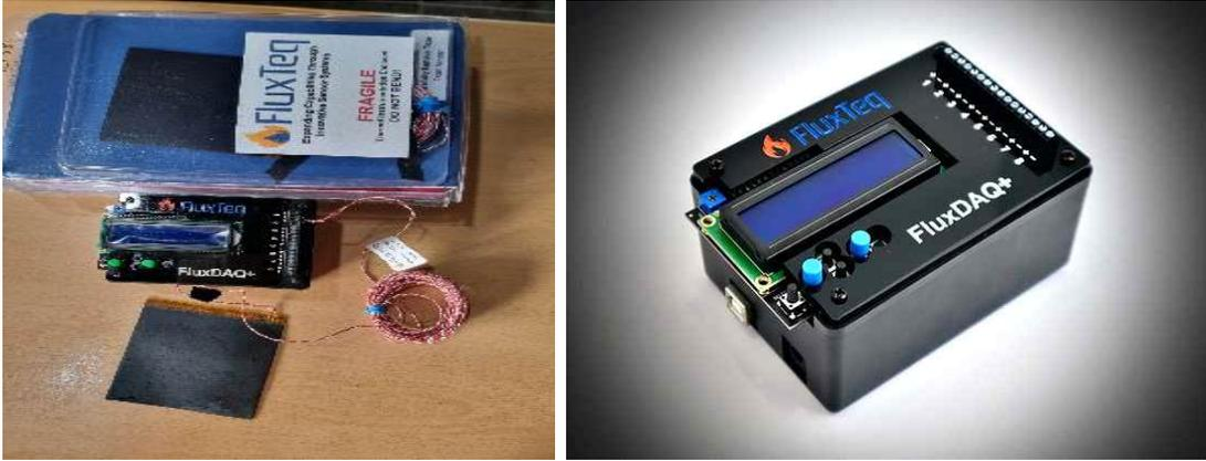
FluxDAQ+는 PHFS 열유량 센서, 통합 열전대 및 독립 열전대 기반 온도 센서의 작은 아날로그 DC 전압 출력 신호를 정확하게 측정하도록 설계된 저가형 Arduino 기반 데이터 수집 시스템입니다. FluxDAQ+를 사용하면 현재 사용 가능한 다른 시스템에 비해 훨씬 저렴한 비용으로 정밀한 측정 분해능을 얻을 수 있습니다.
